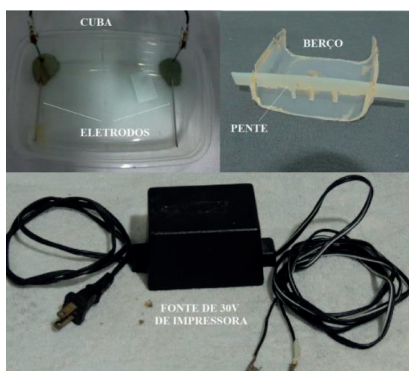
Figura 5 - Primeiro protótipo da cuba, eletrodos, pente e suporte do gel (berço) do kit didático de eletroforese
